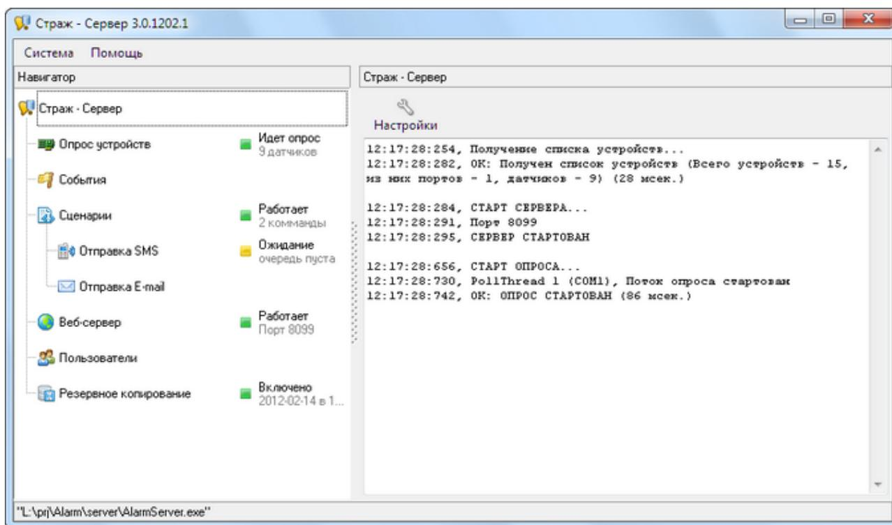
Главное окно "Страж-Сервер" отображает список модулей сервера и состояние их работы. При нажатии на узел (значок) модуля справа отображаются подробности работы модуля и элементы интерфейса для настройки и проверки работы модуля.
