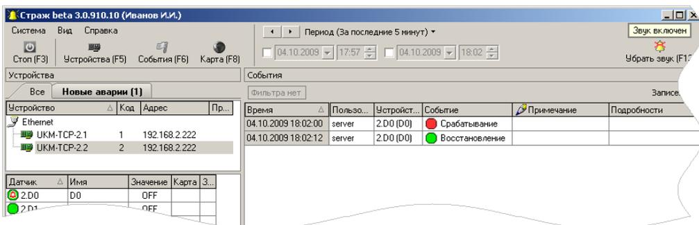
2.4 Оператор замечает не квитированный датчик и производит подтверждение аварии – квитирование датчика. Звук при этом автоматически выключается.
