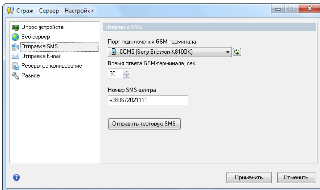
Для отправки SMS-сообщений и дозвона на мобильные телефоны (действие "[Отправка SMS](#)"<sup>[34]</sup>, "[Дозвон](#)"<sup>[35]</sup> в [сценариях](#)<sup>[25]</sup>) используется GSM-терминал или мобильный телефон, подключенный к COM или USB порту компьютера.
