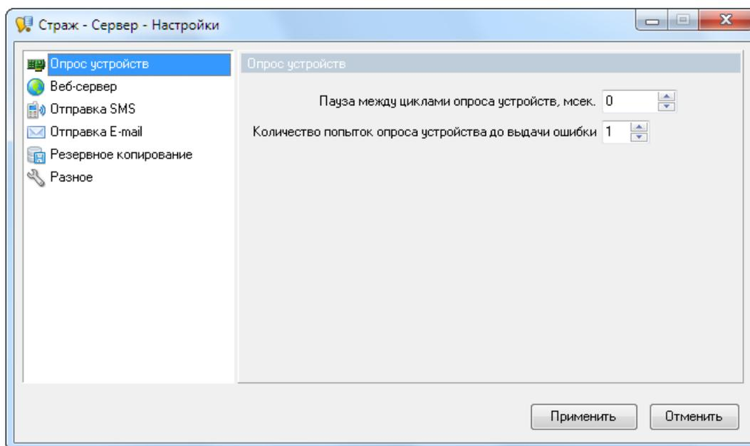
**Пауза между циклами опроса устройств** - задает паузу, которая будет выдержана после опроса состояния очередного устройства. Позволяет уменьшить частоту опроса устройств, и как следствие, скорость роста размера базы данных из-за накопления данных трендов.
