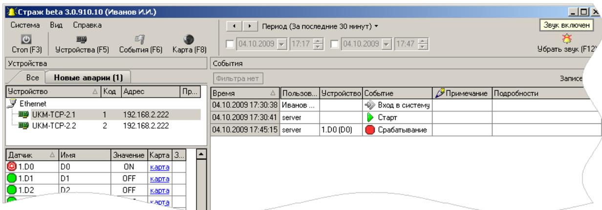
1.3. Если оператор увидел/услышал срабатывание датчика, он производит подтверждение аварии – квитирование датчика. Звук при этом автоматически выключается.
